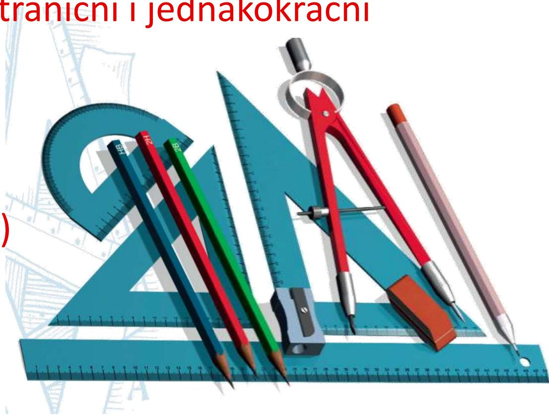
**Pribor za tehničko crtanje** omogućuje preciznu izradu tehničkih crteža – olovke različite tvrdoće, trokuti, kutomjer, ravnalo, šestar i gumica.
